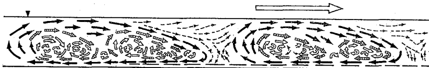
Рис. 1.4. Схема кинематической структуры турбулентного потока, по А. Б. Клавену.
